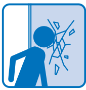
人体衝突による破壊
