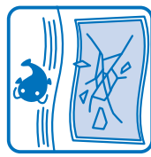
地震時の層間変位による破壊
