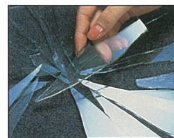
フロートガラスの破損状態
